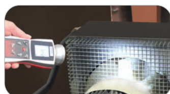
Stroboscopio acceso: rotazioni visibili
