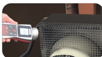
Stroboscopio spento: rotazioni non visibili
